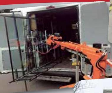
Seitenverschiebung zur Feinjustierung bei der Montage.
