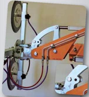
Der Hebekopf hat zwei Einstellmöglichkeiten, durch zwei Löcher für den Sicherheitsbolzen. Dadurch lässt sich der Kippwinkel nach oben oder unten erhöhen.
