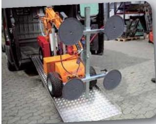
Der Transport des Lifts erfolgt in einem Transporter oder auf einem Anhänger.
