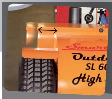
Der SL 608 Outdoor ist bis zu 100 mm seitenschiebbar zur Feinjustierung beim Fenstereinbau.
